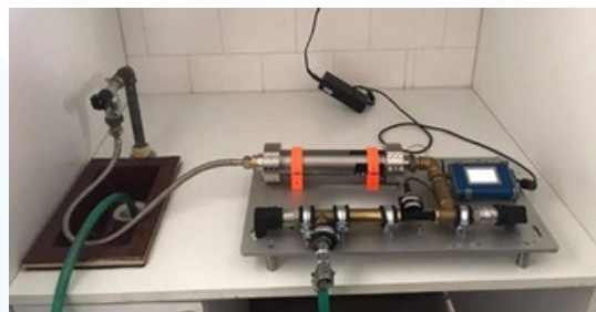
Un dispositivo desarrollado por investigadores para medir el efecto del agua tratada con IPS a diferentes presiones sobre el crecimiento de las plantas.
